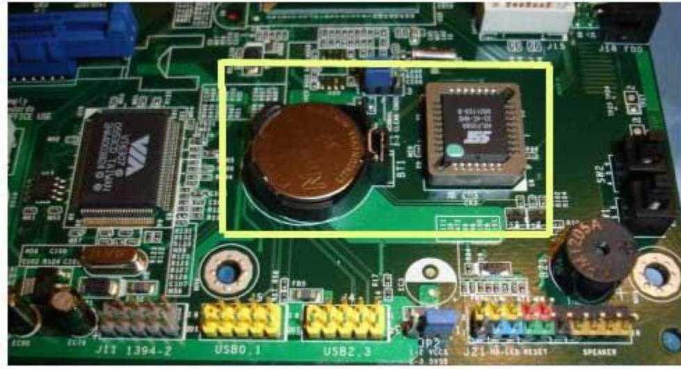
Şekil 62 Anakart üzerindeki Bios pli ve denetçisi
